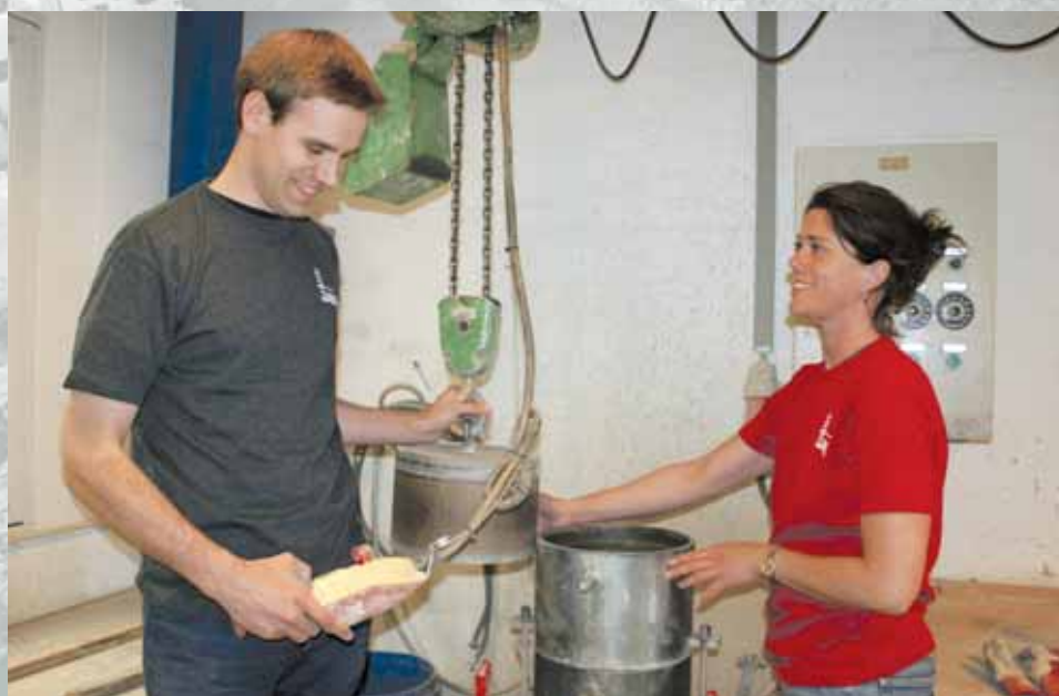
Til grus- og stenprøver bruges den store vibrator/stamper
