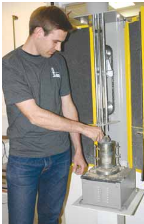
Proctorapparatet bruges især ved sandprøver fra tilsyn
